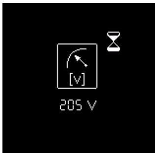
Падение напряжения или сбой электропитания.
