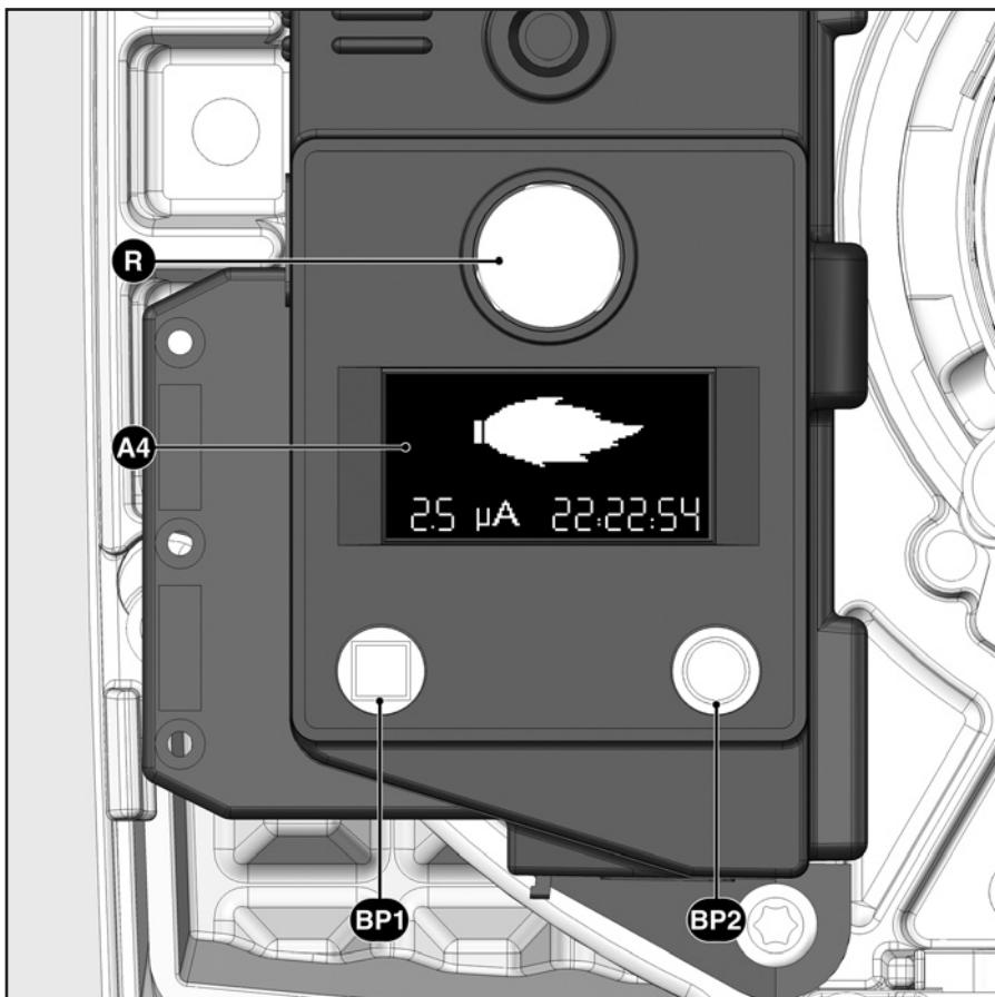
Менеджер горения TCG1xx осуществляет контроль и управление горелкой с наддувом. Благодаря программе, управляемой микропроцессором, обеспечивается максимальная стабильность временных периодов, независимо от колебаний напряжения или окружающей температуры. Менеджер горения защищен от падения напряжения. При падении напряжения ниже минимального значения (< 185 В), менеджер горения отключается и подает сигнал о неисправности. Как только напряжение возвращается к
