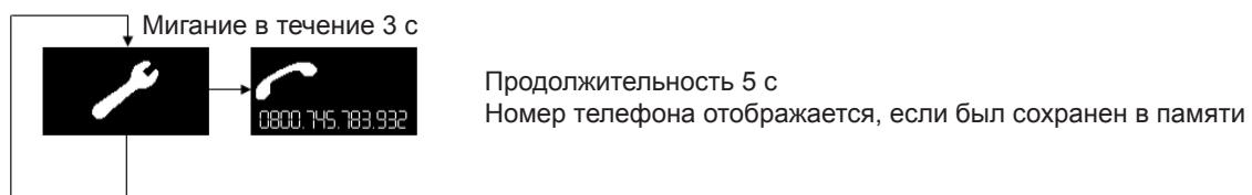
Если пользователь производит сброс данных статистики (нажатием и удерживанием кнопки разблокировки R в течение 9 секунд), пиктограмма "ожидание запроса тепла" снова отображается вместо пиктограммы "требуется техническое обслуживание".
