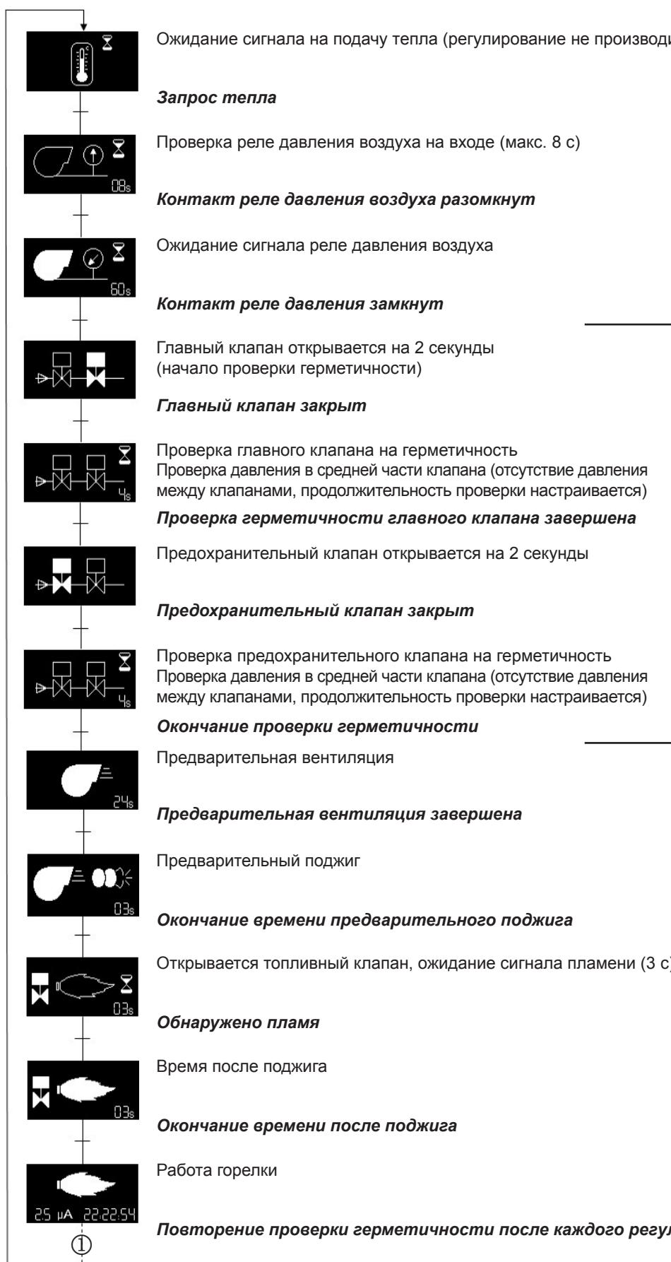
Когда регулирование прекращается, проверка герметичности осуществляется после отключения электропитания
